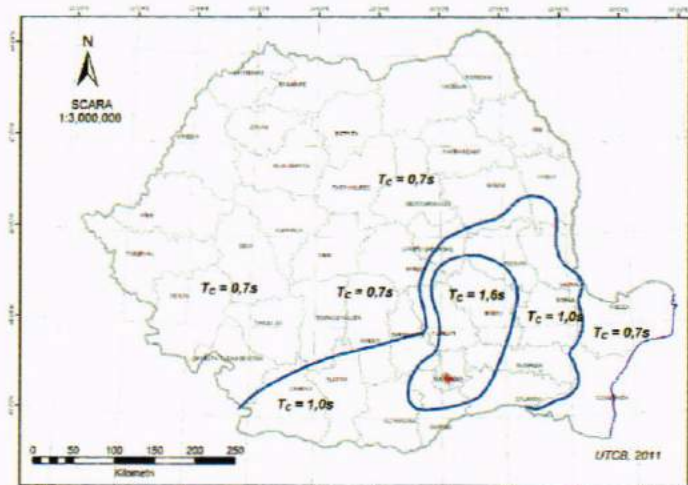
Zonarea teritoriului Romaniei in termeni de perioada de control (colt), T_c a spectrului de răspuns
